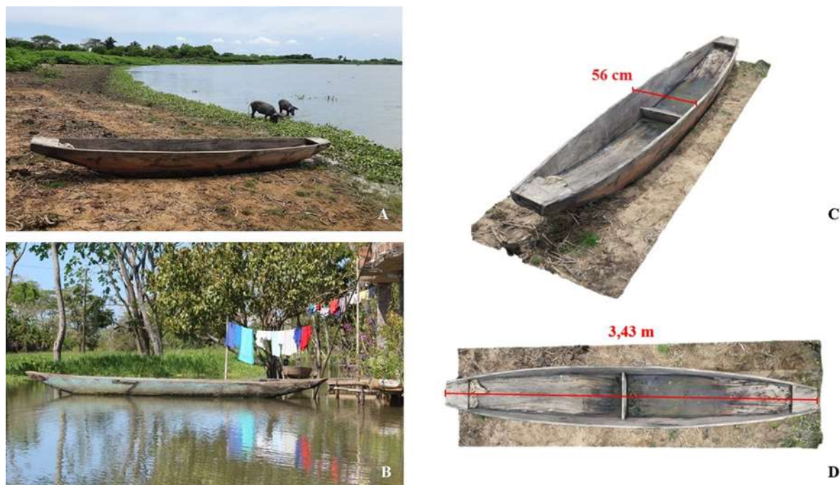
Figura 7. Canoas de tres tablas de eslora 3,43 y manga 56 cm (A, C y D) y de canoa de tablas con bandas compuestas (B).
